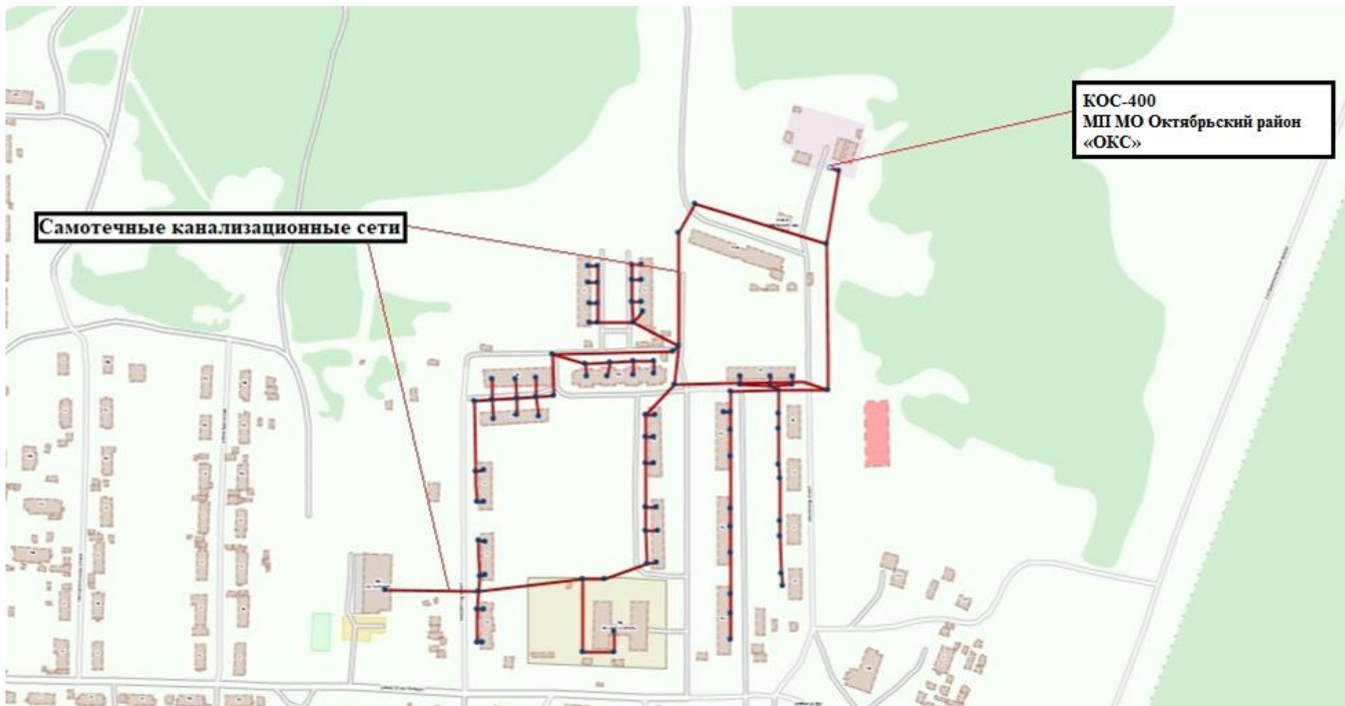
Рисунок 2.1.1.1 – Картограмма зоны действия ТЗ ВО с. Уньюган №1 и расположения входящих в нее объектов ЦС ВО
